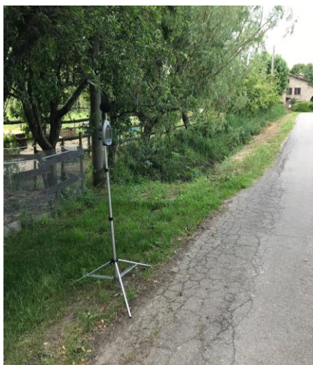
Posizionamento fonometro in prossimità del Ricettore R3
